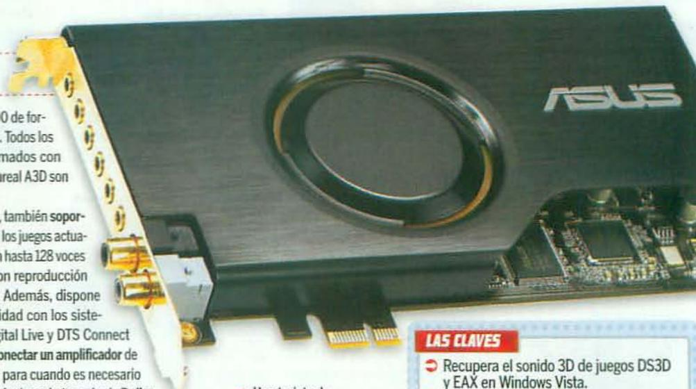
▲ Una tarjeta de sonido a la última en tecnología que introduce una cubierta metálica para aislarla de las interferencias.
